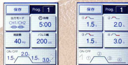
「ランプアップ/ホールドタイム/ランプダウン/ オフタイム」の設定が可能。(EMSモード)
